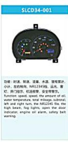
功能：时速、转速、油量、水温、里程累计、小时、左右转向、N123456档、远光、雾灯、安全带、开门报警、机油报警、安全带警告。
