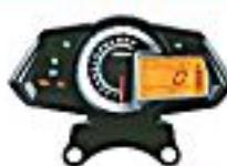
功能：左右转，N档，远光，机油报警，油量显示，转速表，油量表，油量指示，时钟显示。大气温度显示，总小时指示。
