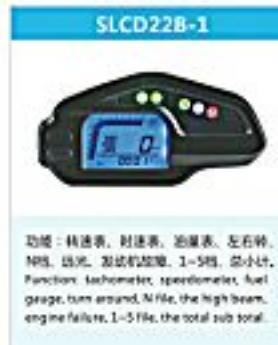
功能：转速表、时速表、油量表、左右转向、0123456档、远光、为电源指示、油量报警、公公里切换或指示。
