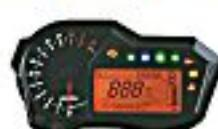
功能：转速，时速，油量，水温，左右转，远光，机油压力，ABS报警，时钟，发动机故障。
