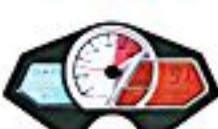
功能：时速显示，转速显示，油量显示，总小时显示，怠速指示，左右转指示，远光显示，N档显示，时钟显示。
