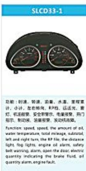
功能：时速、转速、油量、水温、里程累计、小时、左右转向、N123456档、远光、雾灯、安全带、开门报警、机油报警、安全带警告。
