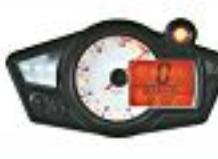
功能：时速，转速，油量，里程累计，小时，左右转向，N档，远光，充电指示，公里数切换或指示。
